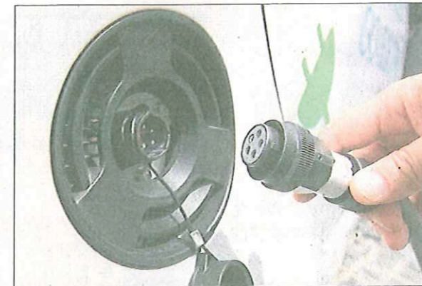
电动车充电只需将电插头衔接到普通的电插座。
