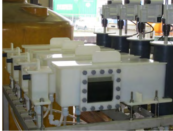
ミキサーセトラー 実証実験機(側方から)
