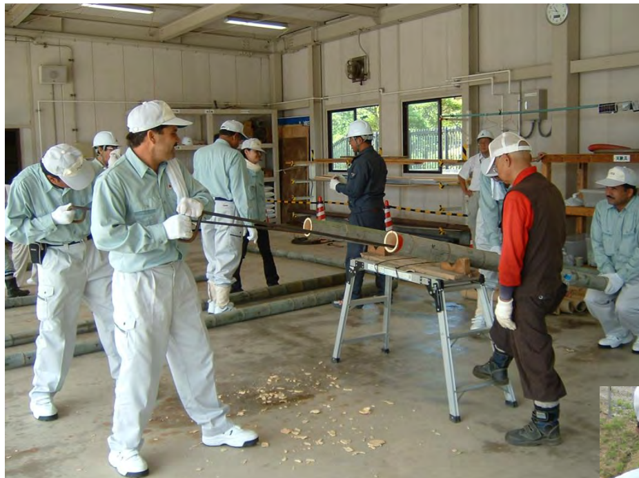
竹を利用した浸出水集排水管製作実習
