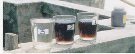
浸出水 (1:原水、2:曝気後、3:ろ過・吸着処理後)
