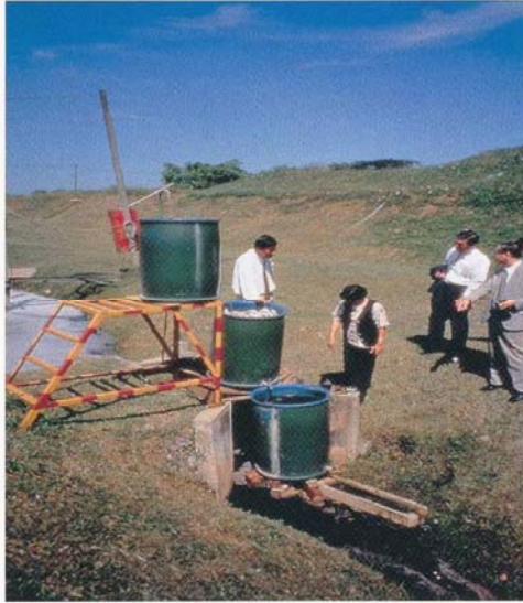
浸出水処理設備 (パイロットプラント)
